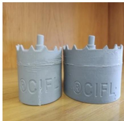
Recolectores de plástico para PCM. 59 mm (izquierda) y 70 mm (derecha)
