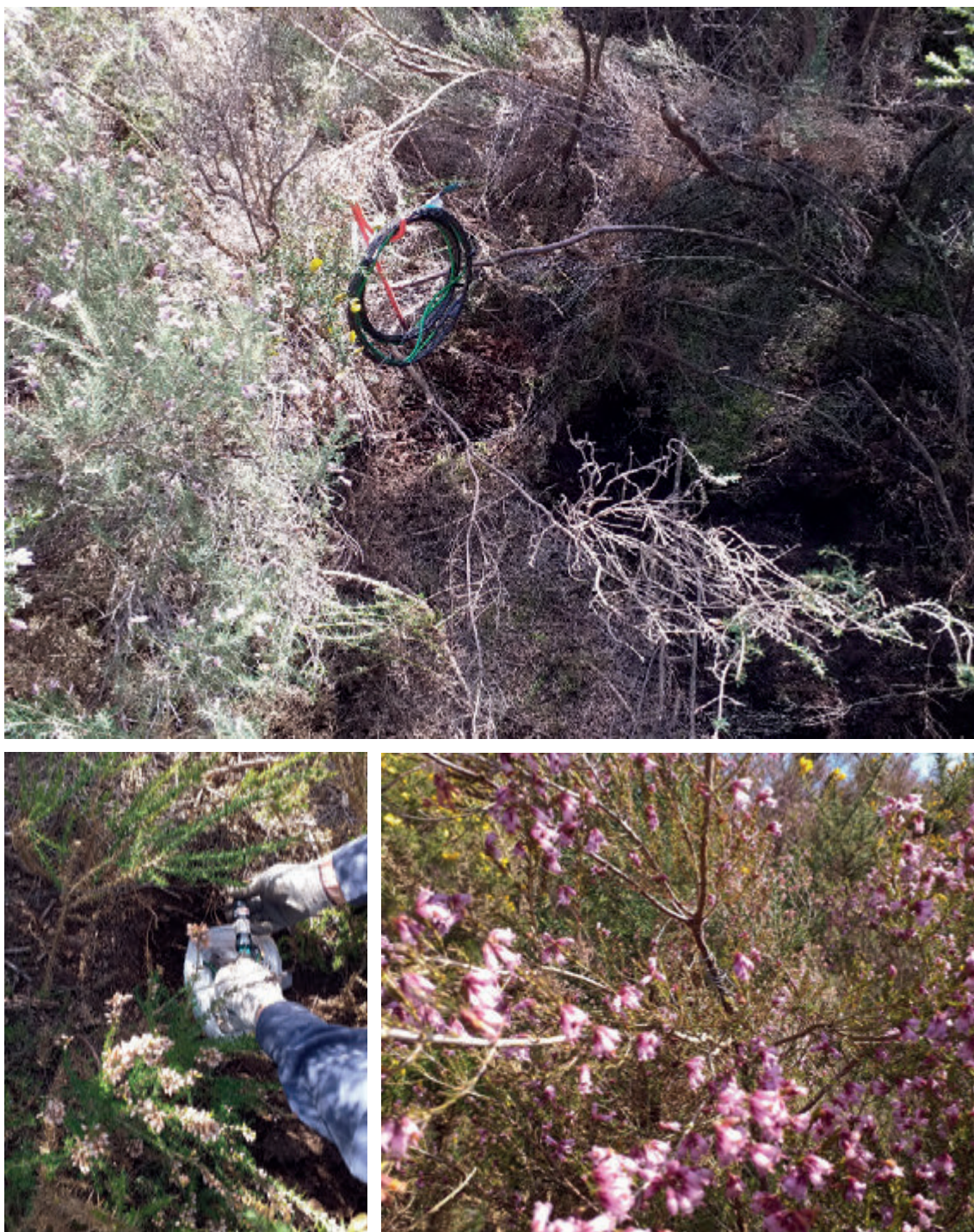
Figura 16. Colocación de termopares y registradores antes de las quemas
