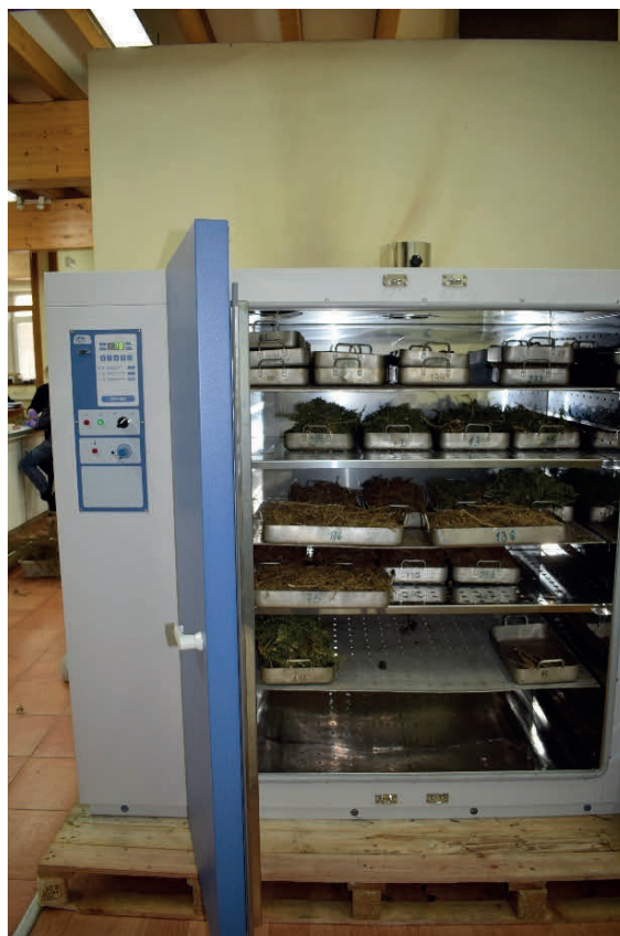
Figura 14. Procesado de los inventarios de combustible en el laboratorio
